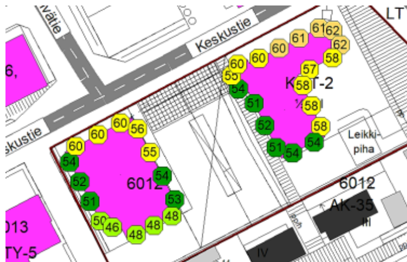
Kuva: Julkisivuihin kohdistuvat suurimmat päiväajan keskiäänitasot.
